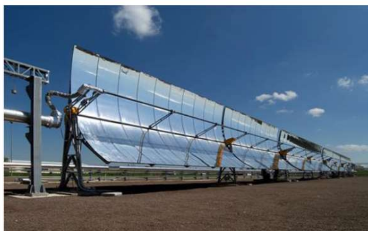
Figura Colectoare cu jgheaburi parabolice
